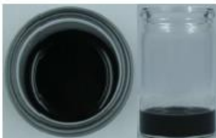
Figura 42- Dispersiones de grafeno en LI
