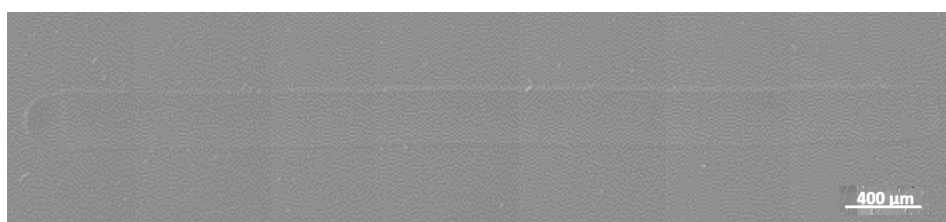
Figura 72- Huella de rayado RE+9%(L108+0,1%G)
