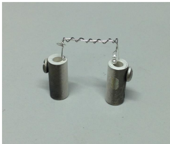
Figura 39. Hilo de tungsteno con 2 filamentos de plata en su interior.
