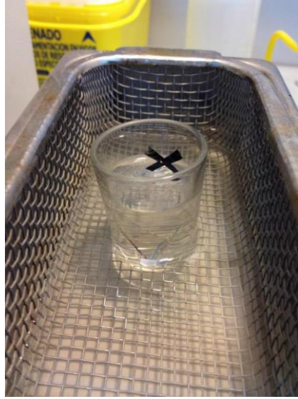
Figura 33. Proceso de limpieza con baño de ultrasonidos.
