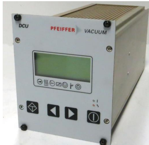
Figura 21. Medidor y controlador PFEIFFER VACCUM DCU150.
