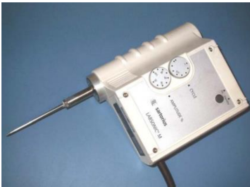
Figura 18. Generador de ultrasonidos de alta eficiencia Labsonic M de Sartorius.
