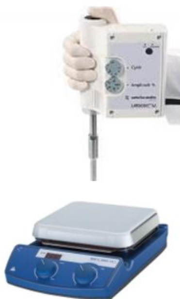
Figura 28. Esquema del equipo de sonicación de una muestra
