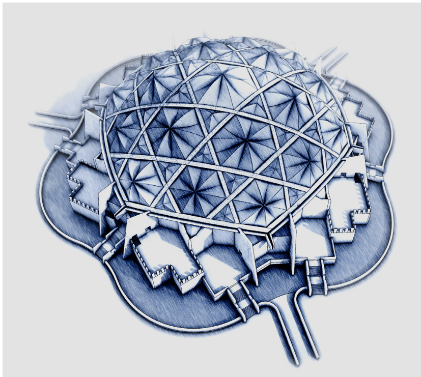
[FIG. 10]. RECONSTITUCIÓN GRÁFICA, PERSPECTIVA AXONOMÉTRICA. ESTRUCTURA FORMADA POR ARCOS ESFÉRICOS Y CERRAMIENTO MEDIANTE FRAGMENTOS DE PARABOLOIDES HIPERBÓLICOS. PROPUESTA DE FÉLIX CANDELA. [IMÁGENES DEL AUTOR].
