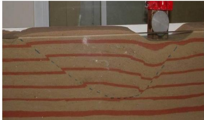
Fig 2.20 Falla por corte de un suelo
