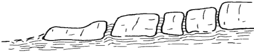
Fig 2.19 Fluencia y extrusión del material subyacente
