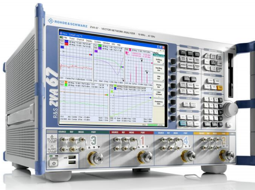
Figura 18. Analizador de redes usado para realizar las medidas [22].
