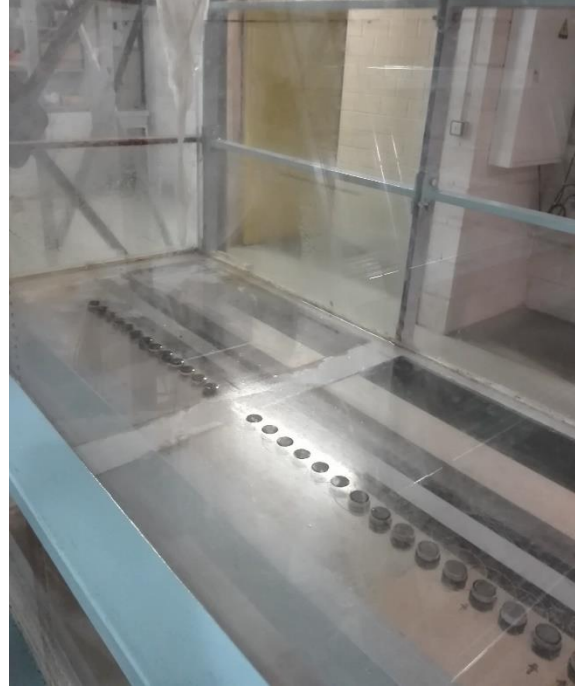
Figura 34. Detalle de los sensores del cuenco de disipación.
