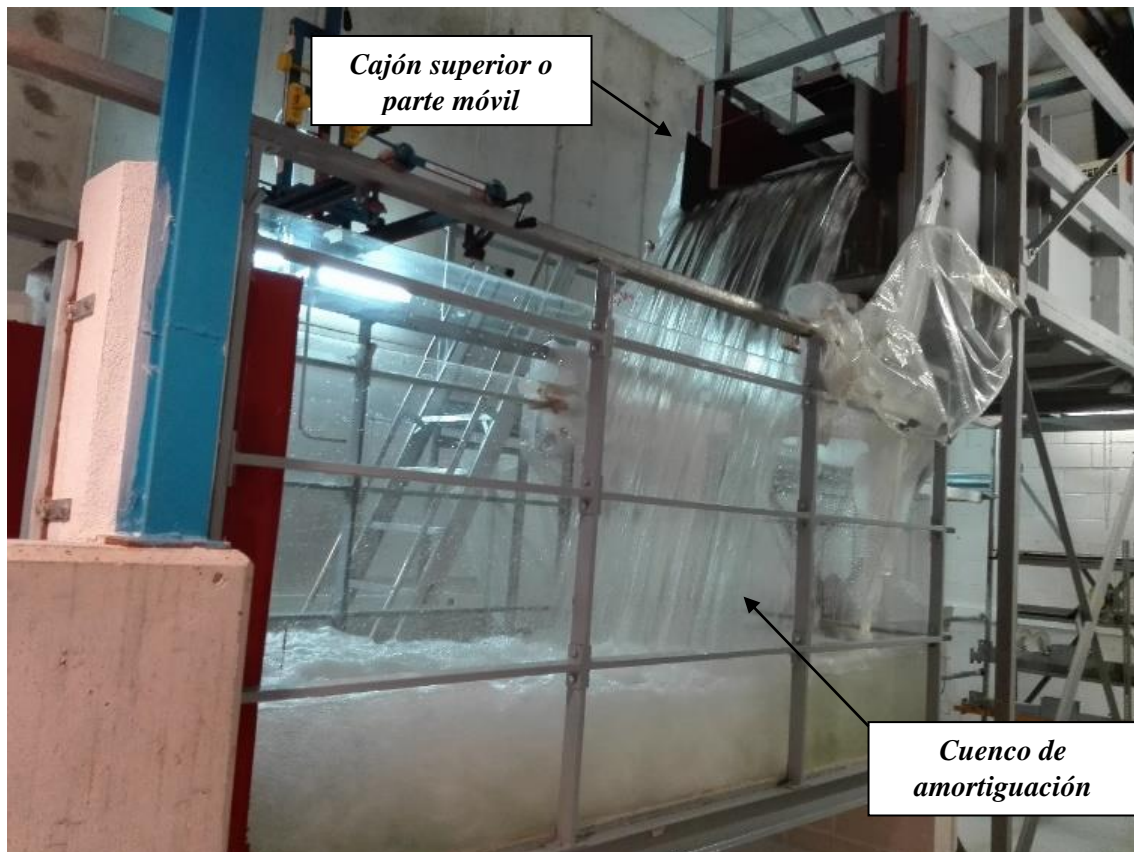
Figura 28. Infraestructura de laboratorio para el estudio de chorros turbulentos y bifásicos.
