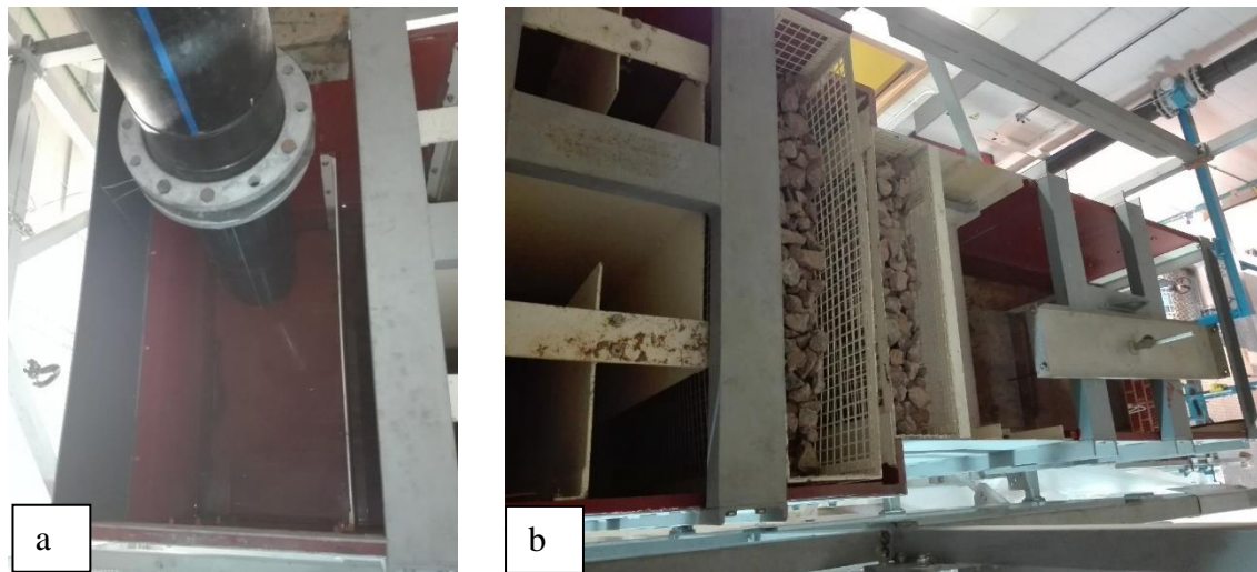
Figura 31. a) Llegada del agua al canal de entrada. b) Canal de entrada con sus respectivos elementos de disipación y orientación de líneas de corriente.
