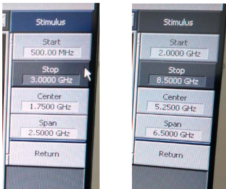
Figura 15- Frecuencias Start y Stop de ambas antenas
