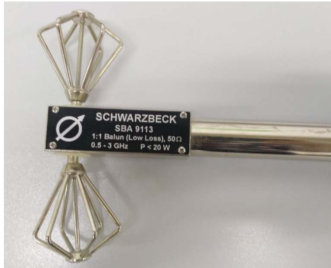
Figura 3- Antena bicónica SCHWARZBECK SBA 9113. [SCHW9113]
