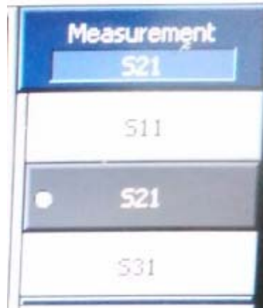
Figura 14- Selección de S21 en el menú Measurement
