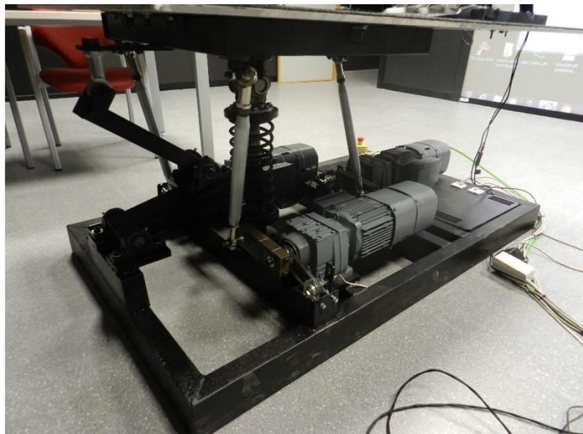
Figura 14. Motores de la plataforma móvil
