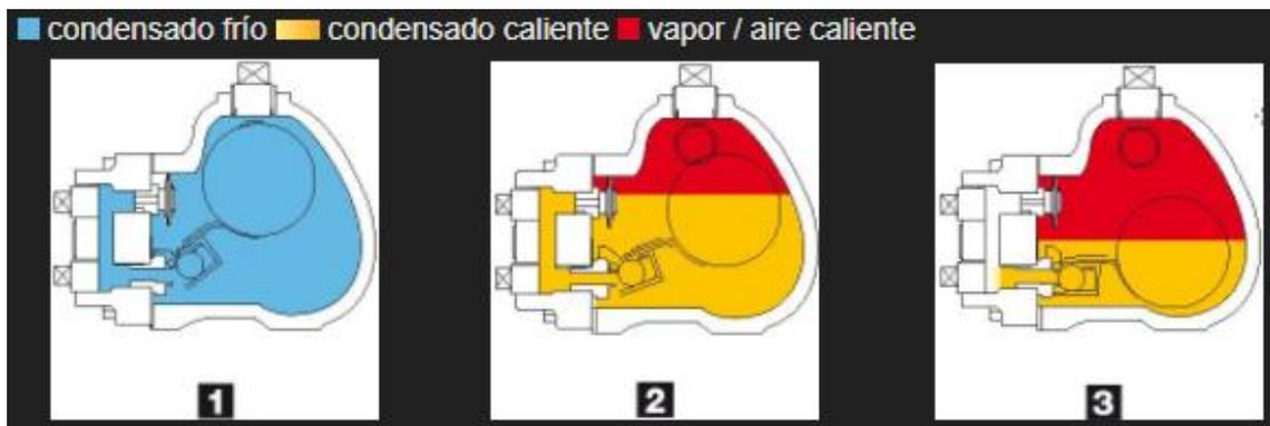
Figura 6.13. Esquema de funcionamiento de una trampa de vapor de tipo flotador. Fuente: Miyawaki
