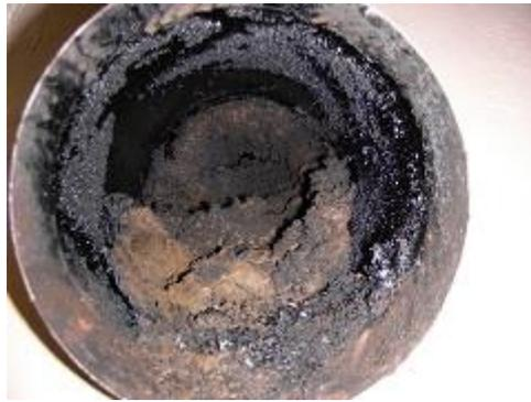
Figura 4.11. Tubo con hollín en las paredes.
