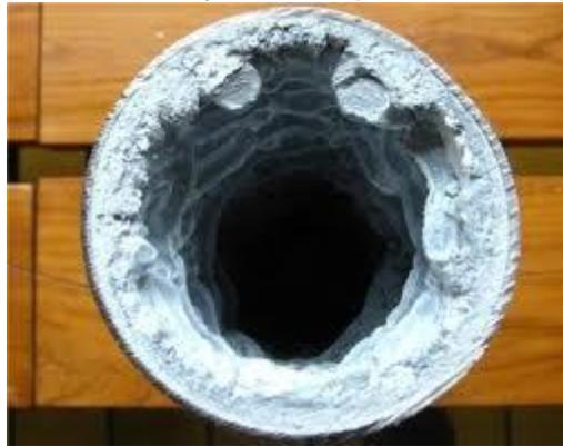
Figura 4.9. Ejemplo de tubo con las paredes llenas de precipitado de sales.
