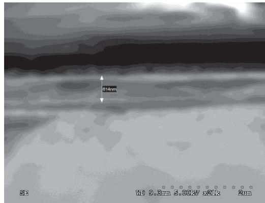
Fig. 3. Imagen SEM del espesor de la película.
