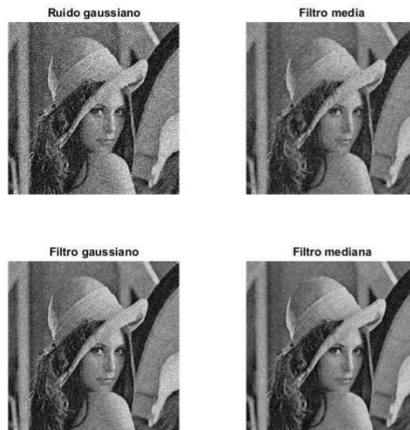
Figura 36: Efecto de los filtros descritos con el ruido gaussiano.
