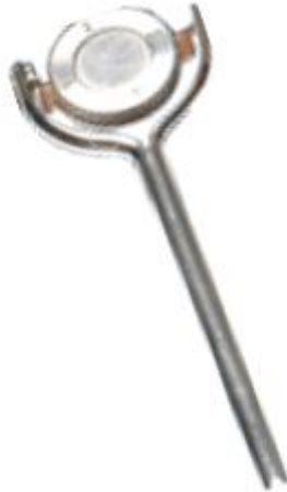
Figura 4: Cruz de Berthold. El disco lleva dos muescas perpendiculares que serán detectadas con iguales intensidades si el magnetismo es el adecuado.
