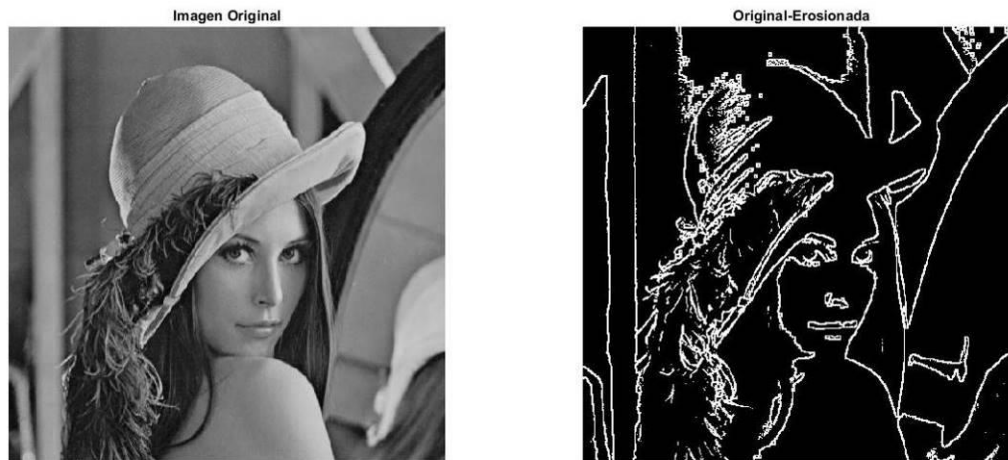
Figura 24: Detección de bordes en una imagen en escala de grises.
