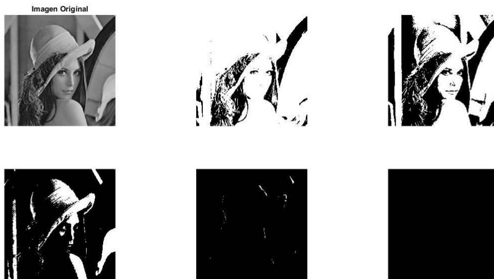
Figura 28: Umbralización para distintos valores del umbral (0.2, 0.4, 0.6, 0.8 y 1)
