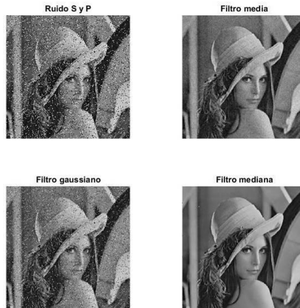
Figura 37: Efecto de los filtros descritos con el ruido sal y pimienta.
