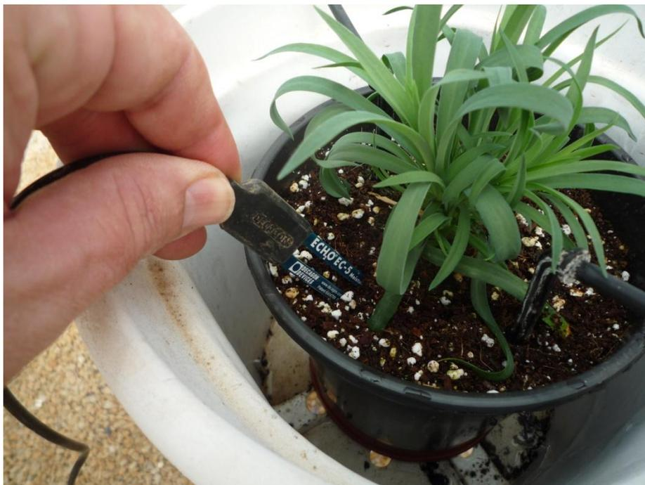
**Foto 10.-** Detalle de la sonda de humedad del sustrato EC-5.
