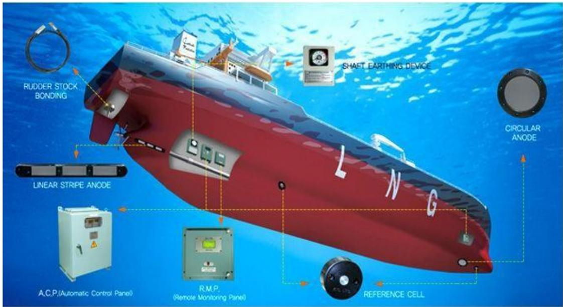
Figura 40: Esquema ejemplo circuito corrientes impresas. (Cathelco)
