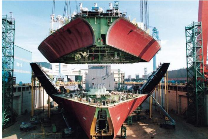
**Imagen 19: Construcción del buque por secciones (Atmosferis, 2013)**
