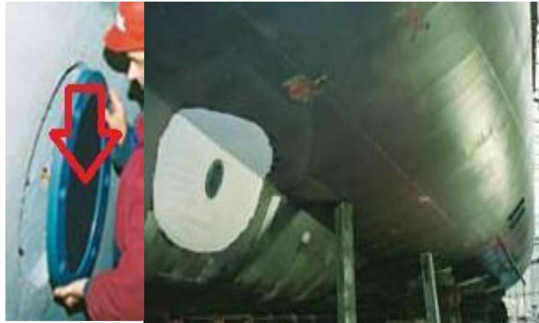
**Figura 37: Instalación ánodo de referencia. (Cathelco)**
