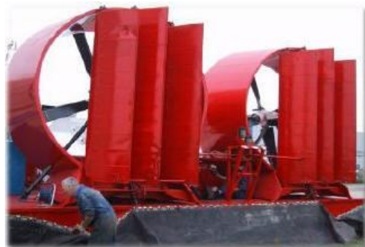
Figura 4.7 Vehículo de colchón de aire el cual está provisto de este tipo de timones de dirección.
