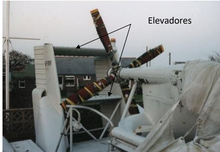
Figura 4.8. Vehículo de colchón de aire SR.N6 el cual tiene un par de elevadores.
