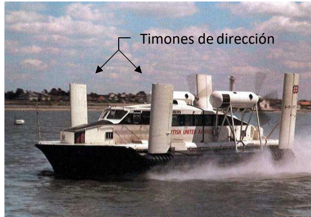
Figura 4.5 El vehículo VA 3 ejemplifica el uso de estos timones como medio de control.
