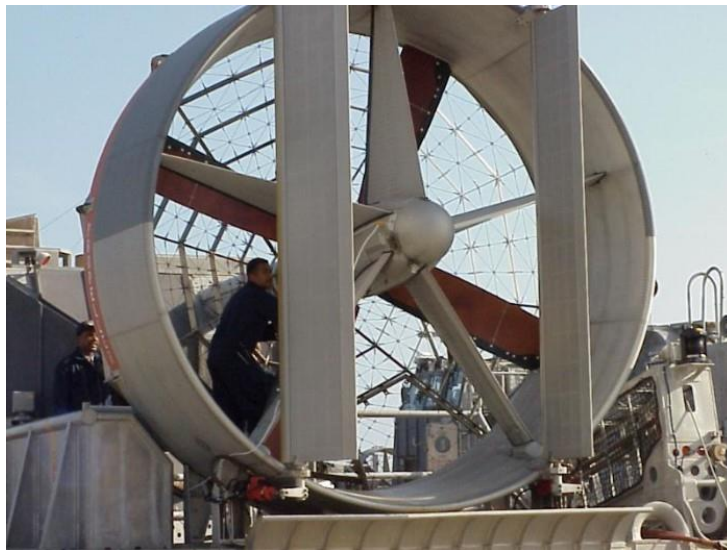
Figura 4.12. Hélice de paso variable en el vehículo LCAC-91.
