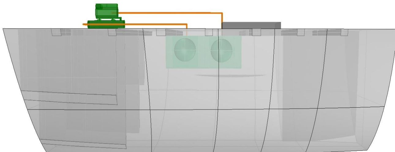
Figura 25: Perfil de la bodega (vacía) con instalación de frío
