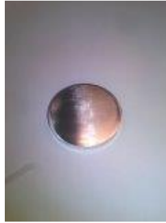
Ilustración 29 Probeta Al7075 T6 pulida
