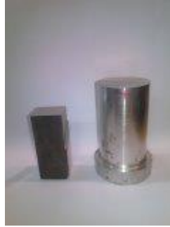
Ilustración 27 Piezas de aluminio 6061 T6 (izda.) y 7075 T6 (dcha.)
