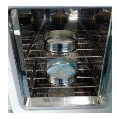
Fig.14. Horno para la obtención de microplasticos.
