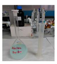
Fig.16.Matraz aforado volumétrico con el contenido de la solución madre.
