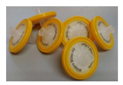
Fig.19. Preparación de la muestra (filtrado).
