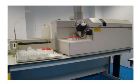
Fig.21. Espectrómetro de masas de plasma acoplado inductivamente AGILENT 7500CE. Fuente: SAIT UPCT.
