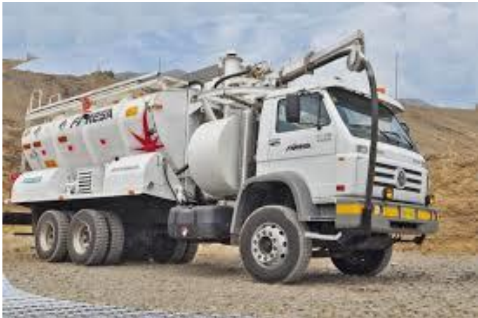
Ilustración 2. Camión de transporte de explosivo
