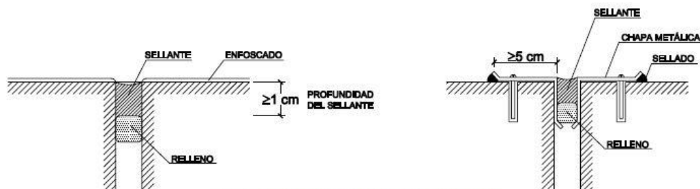
Figura 2.6 Ejemplos de juntas de dilatación
