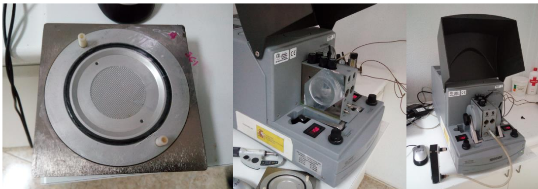
Figura 2.17: Colocación de las muestras en el permeabilímetro.
