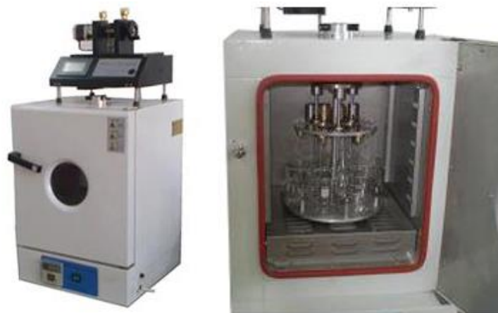
Figura 2.21: Dip Coater con control de temperatura y humedad.
