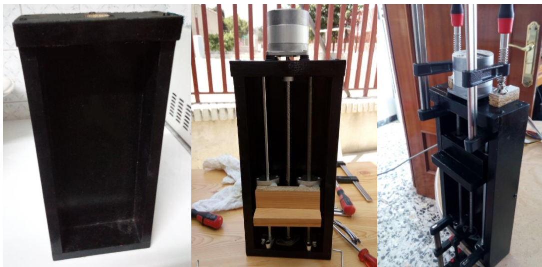
Figura 3.52: Fases de construcción del sistema de inmersión.
