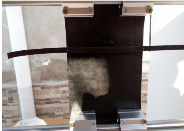
Figura 3.59: Sujeción de un extremo de la correa.
