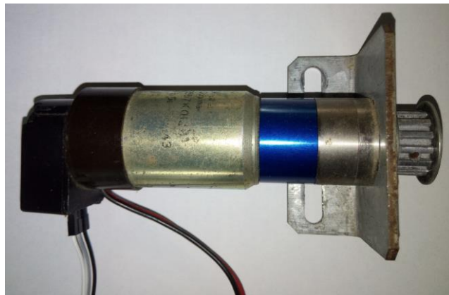
Figura 3.15: Motor DC Faulhaber 3557 012 CS
