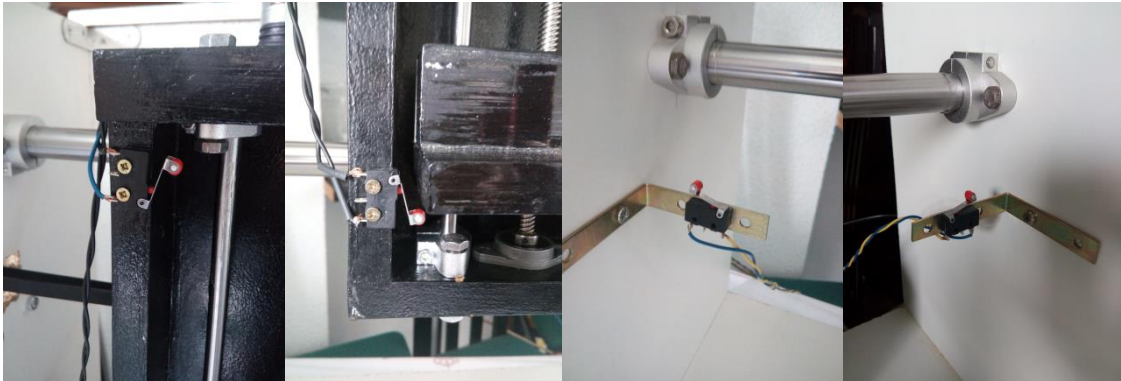
Figura 3.63: Colocación de los finales de carrera.
