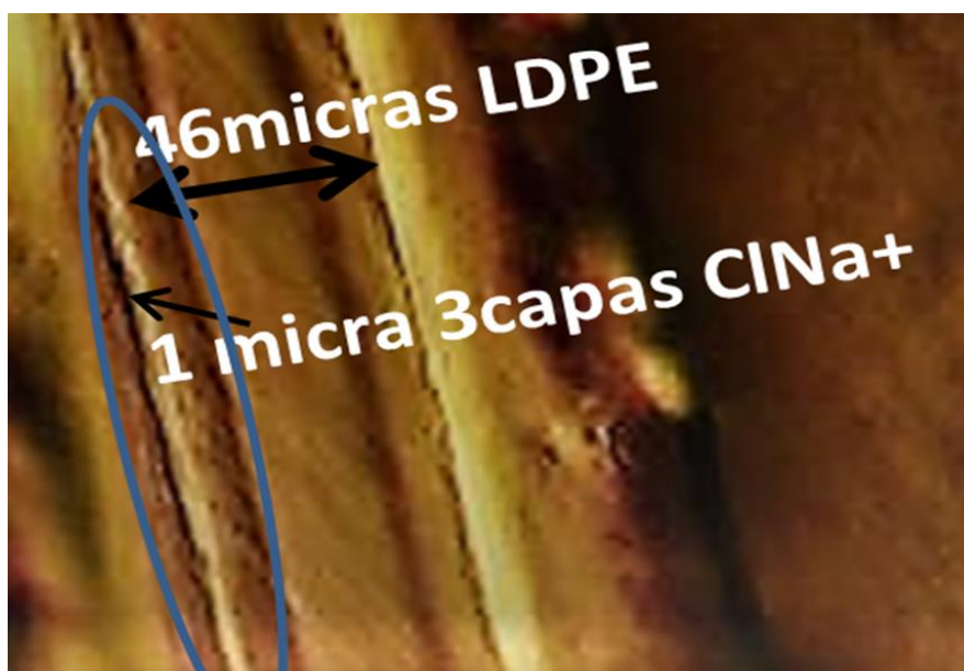
Figura 4.11: Estructura formada sobre la superficie del film.
