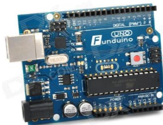
Figura 3.27: Controlador Funduino UNO.
