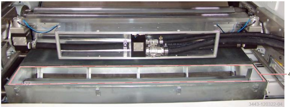
Figura 66. Desmontaje y limpieza de secador intermedio lateral (4/5).
