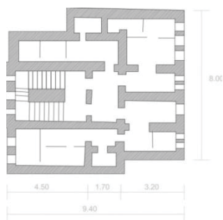
Fig. 3. Planta tipo de casa torre. Elaboración propia a partir de Ortega (2008).
