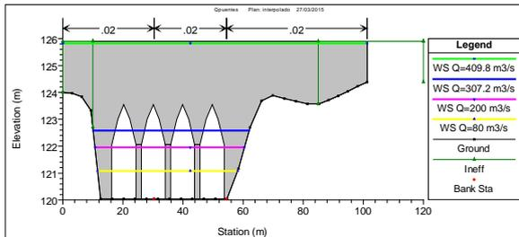
Fig. 3. Simulación numérica del puente de San Francisco situado en Fuente Álamo con los diferentes caudales de la tabla 1.
