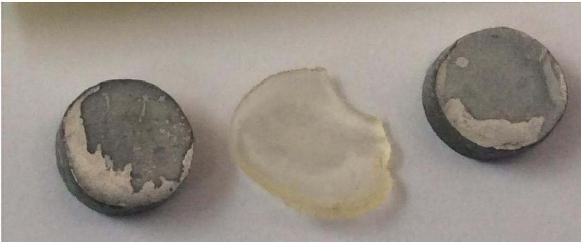
*Ilustración 16: Electroodos de Zn y la membrana sintetizada tras la realización de la prueba de voltametría cíclica.*
