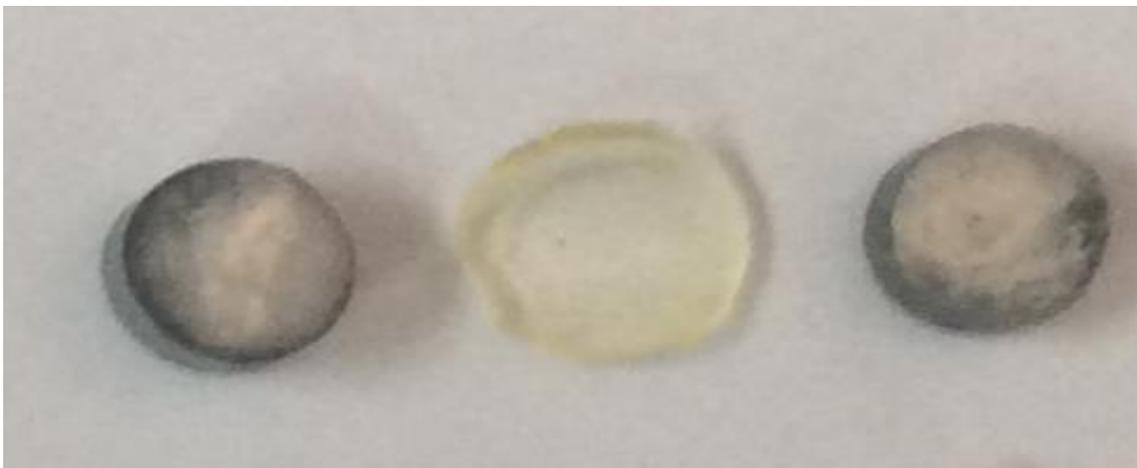
*Ilustración 17: Electroodos de Zn y la membrana sintetizada tras la realización de la prueba de voltametría cíclica.*
