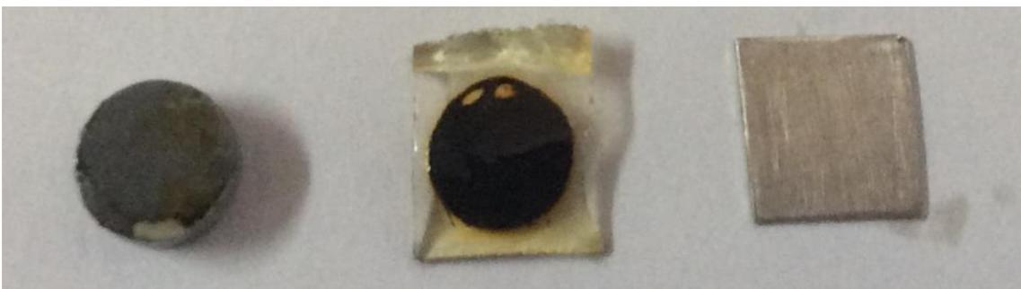
*Ilustración 18: Electroodos de Zn y de Pt y la membrana sintetizada una vez realizada la prueba estabilidad electroquímica (voltamperometría de barrido lineal). El electrodo de Pt sirve para realizar la prueba EDX.*
