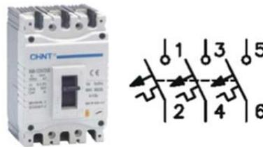
La tensión de servicio para este modelo magneto térmico varía dependiendo del número de polos que se conecten en serie. La tensión máxima que se puede generar a la salida del generador FV serán 589512 V en condiciones de circuito abierto y temperatura mínima, por tanto se conectarán los tres polos en serie ya que cada polo en serie conectado soporta una tensión de servicio de 250 Vcc y con los tres polos conectados se logra una tensión máxima que puedan generar los módulos solares.
