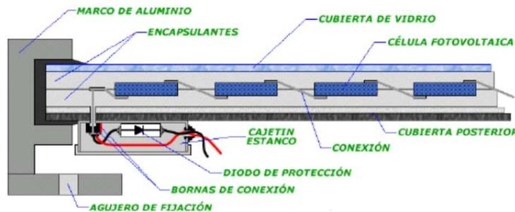
figura 6: Elementos de una panel Fotovoltaico
