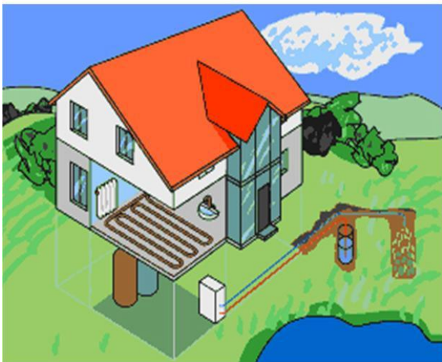
Figura 15 Bomba de calor con fuente fría el agua (pozo) o con fuente fría el suelo [3].
