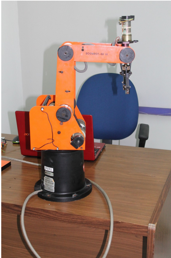
Figura A.1: SCORBOT-ER III en posición inicial.
