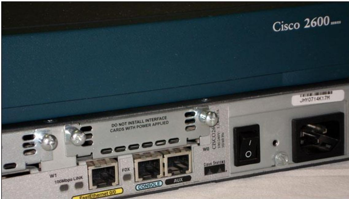
Figura 21.b. Router CISCO2620XM. Los empleados en el laboratorio poseían una tarjeta serial de un único puerto.
