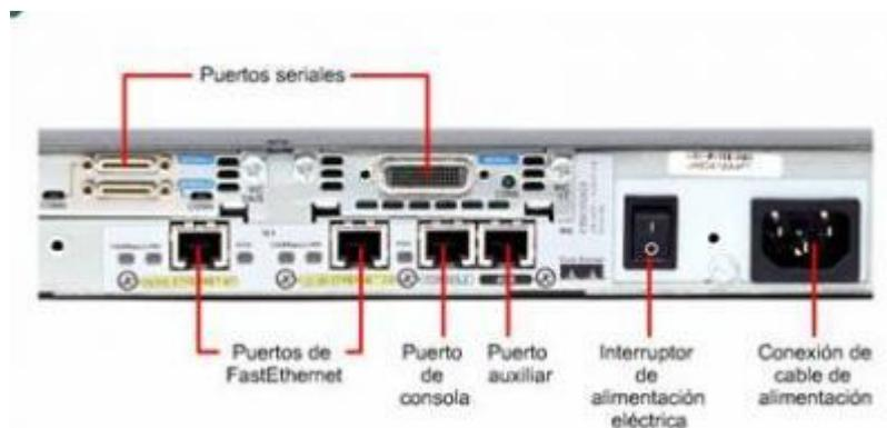
Figura 21.a. Router CISCO 2611XM con descripción de los puertos. El usado en el laboratorio sólo disponía de una tarjeta serial de 2 puertos, como la que se ve a la izquierda de la imagen.
