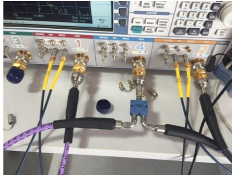
Figura 4.11. Conexión cableado VNA.
