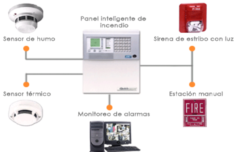
Imagen 2. Sensores automáticos y sistemas manuales de alarma
