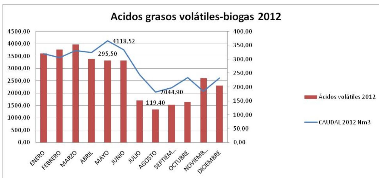
Figura 5.18. Correlación entre el valor medio mensual de AGV en el digestor y el caudal medio mensual de biogás producido en el año 2012.
