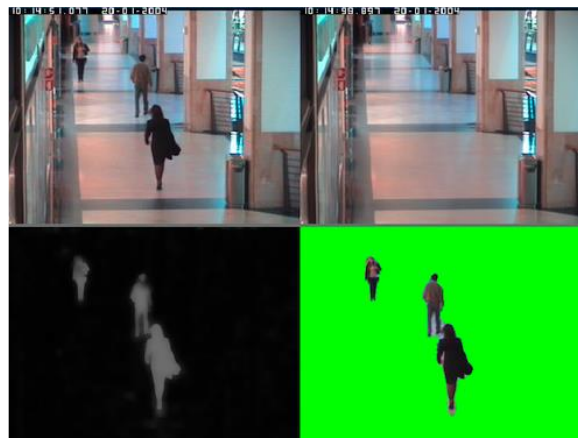
Figura 2.28: Detección de personas en cámara de video vigilancia. La imagen superior derecha es la imagen de referencia (background).
