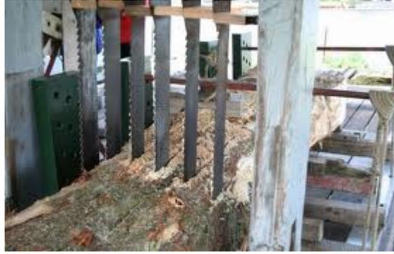
La tabla central se corta según el plano de simetría del tronco, es la única que tendrá fibras continuas y con forma regular, esta tabla central es la que mejores propiedades mecánicas tendrá debido a esta regularidad en la estructura interna. El resto de tablas son de una calidad inferior y tienen una tendencia a deformarse con los cambios de humedad interior. Esta madera corriente se intenta utilizar lo mínimo posible en la construcción naval.
