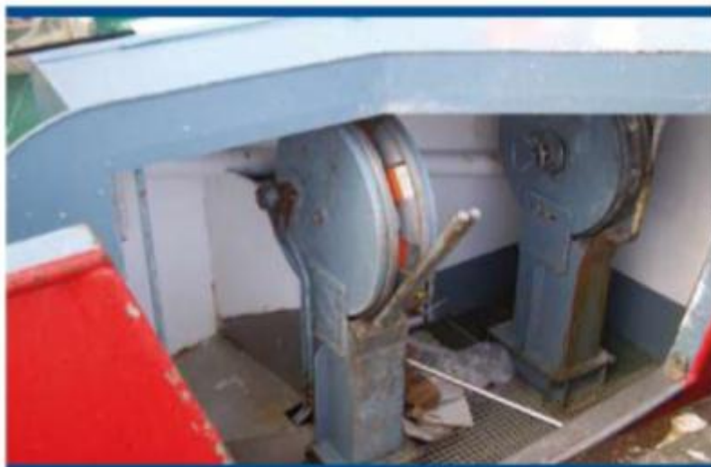
Halador hidráulico a bordo de un palangrero.
