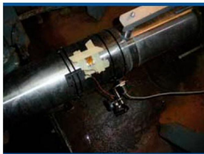
Galgas y emisor de torsiómetro instalados en el eje
