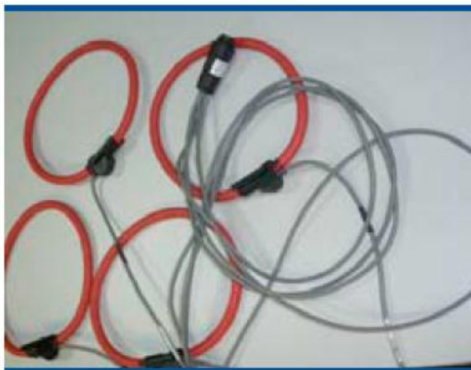
Sensor eléctrico trifásico (detalle de los anillos amperimétricos)
