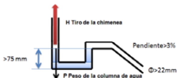
Figura 40: Desagüe de condensados de la caldera.
