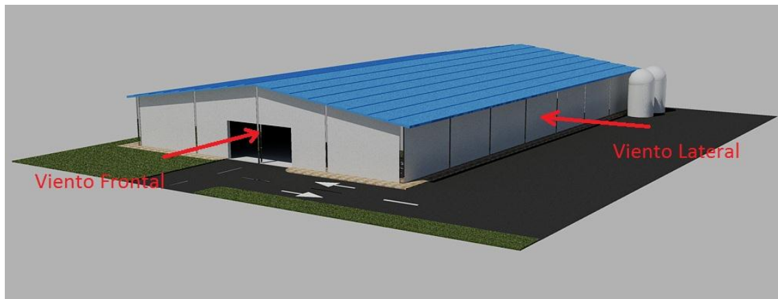
Figura 2.3: Distribución de viento sobre fachadas
