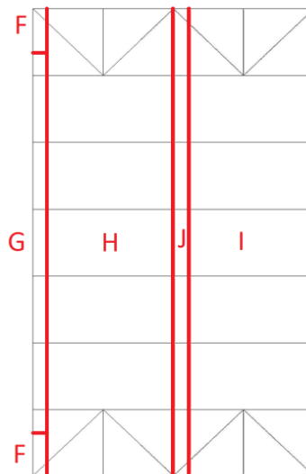
Figura 2.5: Distribución de coeficientes eólicos sobre cubiertas
