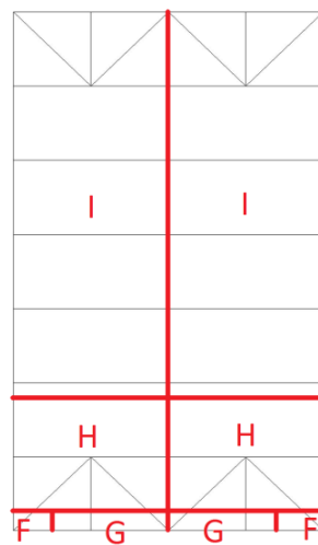
Figura 2.8: Distribución de coeficientes eólicos sobre cubierta
