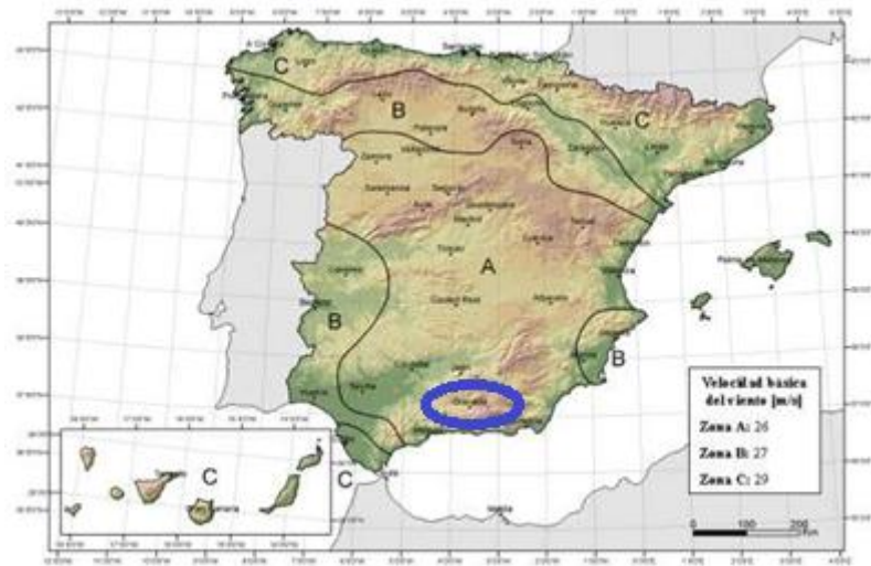
Figura 2.2: Mapa de velocidad básica del viento (CTE DB SE AE)
