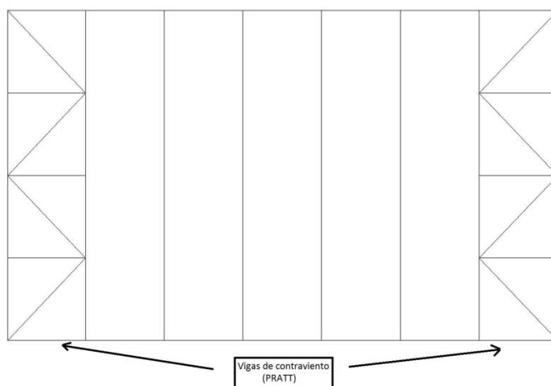
Figura 1.6: Disposición de las vigas de contraviento
