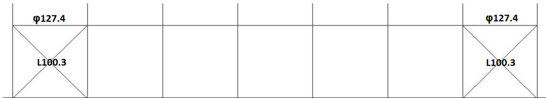
Figura 4.39: Solución final arriostramiento fachada lateral
