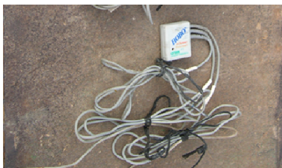
Foto 26. Datalogger con sondas para el registro de las temperaturas del suelo (15 y 30 cm) y del ambiente.
