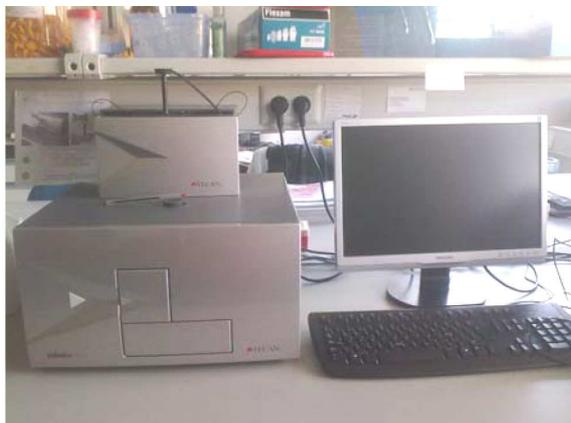
**Figura 7:** Lector de placas Infinite M200 de la casa comercial Tecan.
