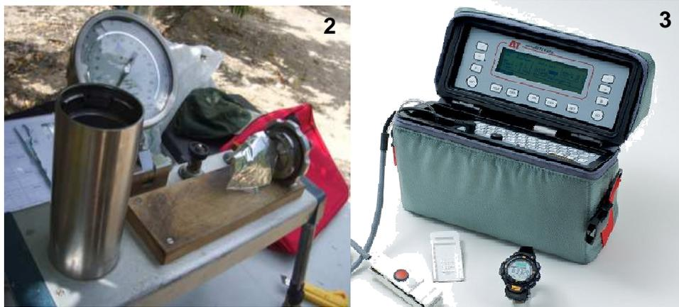
**Figuras 2 y 3:** Cámara de presión y Porómetro portátil (LI-6400, LI-COR Inc., Lincoln)
