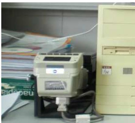
**Figura 5:** Colorímetro Minolta CM-508i
