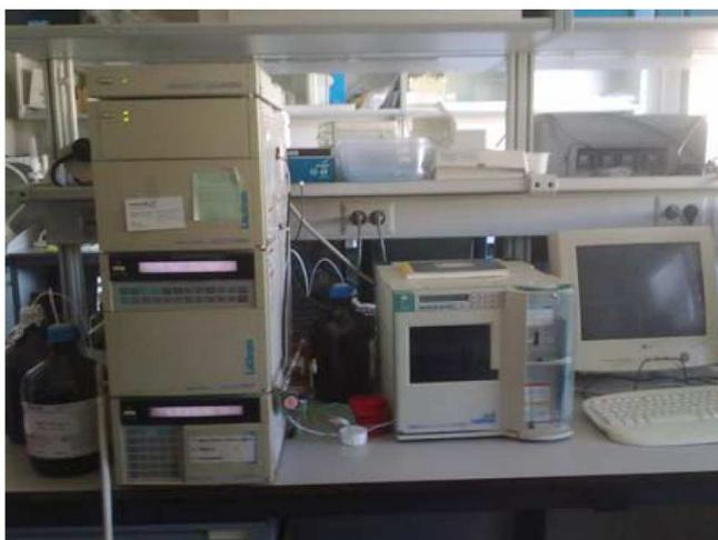
**Figura 6:** Equipo HPLC utilizado en los análisis (Merck-Hitachi)
