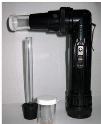
Ilustración 26. - Aspirador entomológico automático
