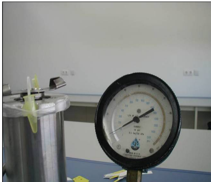
Fotografía MM.11.- Medida de la conductividad hidráulica de las raíces.
