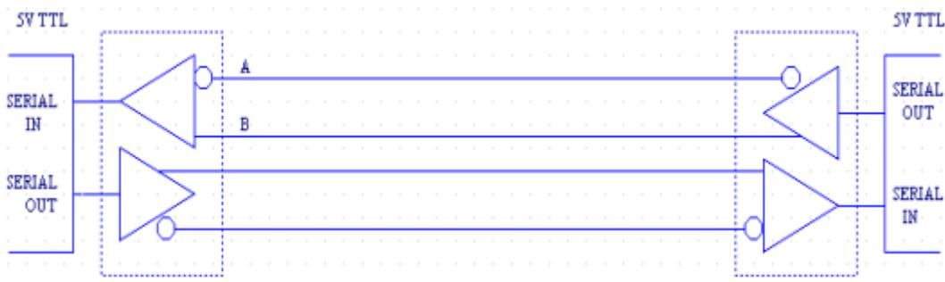
**Fig.3.41.** Comunicación en Full-Dúplex
