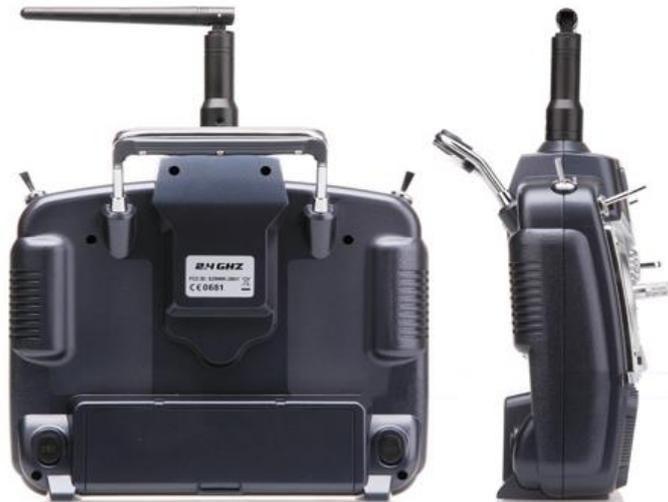
*Fig.2.31. Mando con tecnología de emisión Spread Spectrum*
