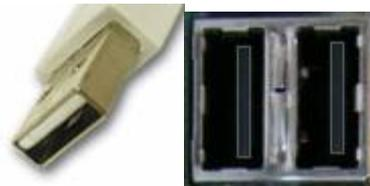
**Fig. 2.35.** Conector USB macho del "Gamepad" y puertos USB hembra
