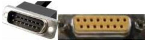
**Fig. 2.34.** Conector DB-15 macho del "Gamepad" (izda.) conector DB-15 hembra de la tarjeta de sonido (dcha.)
