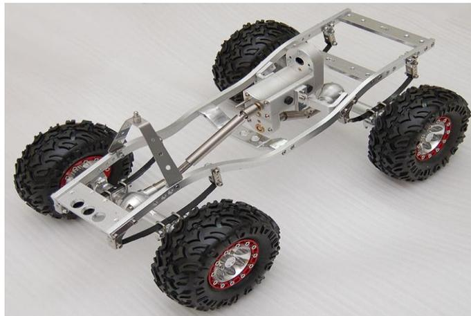
*Fig.2.29. Chasis coche radiocontrol*
