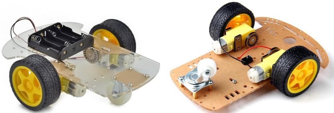
*Fig.4.1. Vistas superior (izda.) e inferior (dcha.) del robot car Arduino 2WD*
