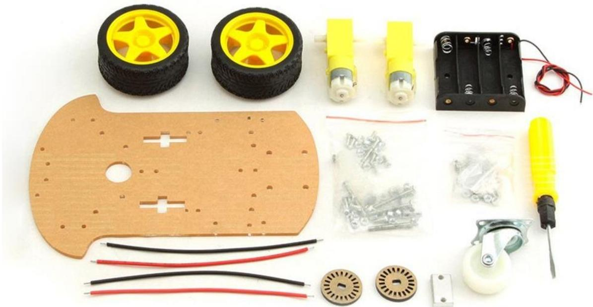
*Fig.4.2. Elementos del kit car Arduino 2WD*
