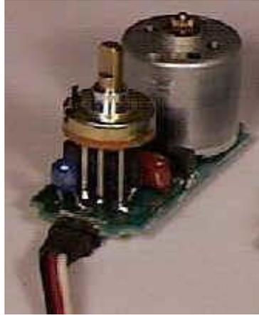
**Fig.2.19.** Circuito de control y realimentación
