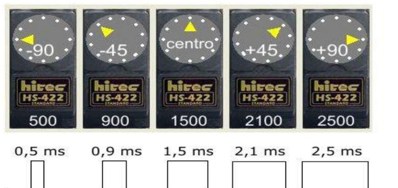
**Fig.2.9.** Control del servo basado en el ancho de pulso
