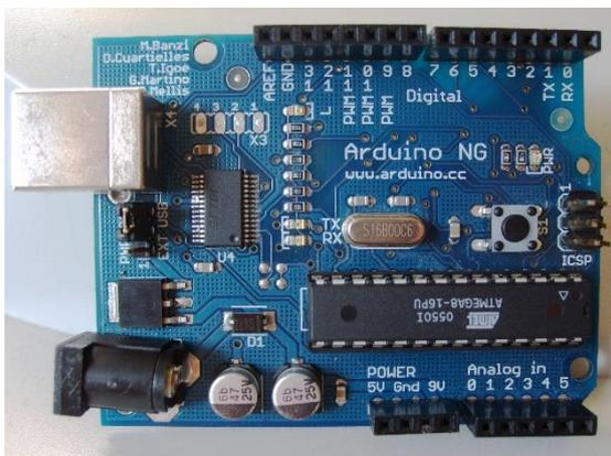
Usa el convertor serie a USB FTDI FT232RL, el cual necesita menos componentes externos que el FT232BM. Este también posee un LED en el pin 13, aunque en su última revisión se eliminó este LED porque podía interferir con la comunicación SPI. Originalmente comercializado con el ATmega8, paso a producirse en base al ATmega168
