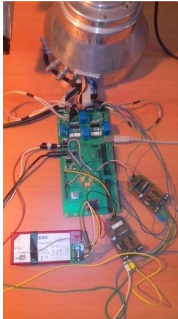
Figura 9 Plataforma AER-Robot y Puentes H auxiliares
