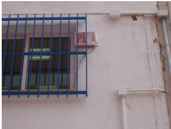
Figura 28. Sondas de temperatura exterior cubiertas con cartón.
