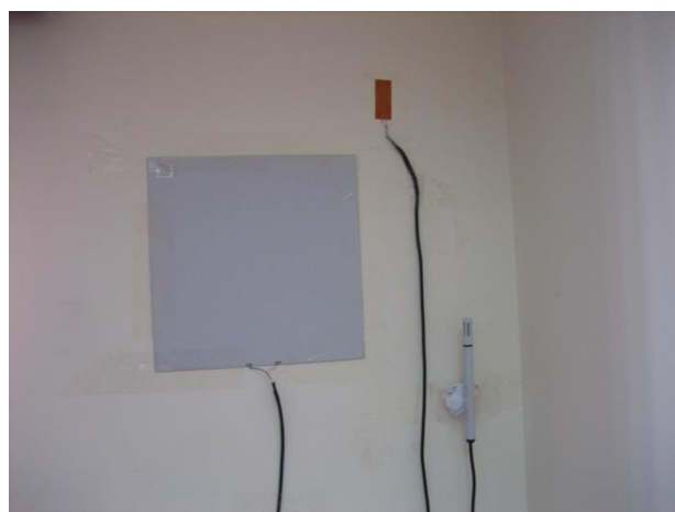
Figura 26. Situación de la HFM y las sondas de temperatura interior.
