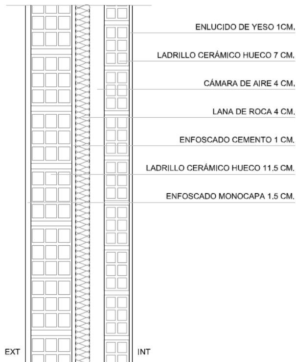
Figura 20. Capas del cerramiento 1.
