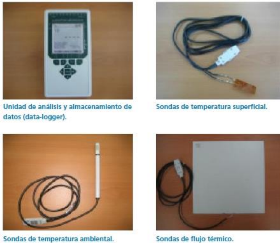
Figura 4. Equipo para la realización de la prueba de termoflujometría.
