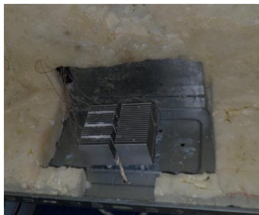
Figura 5.4 Disipador interior encima de la cara caliente
