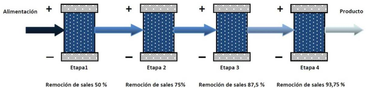
Figura 66. Esquema etapas hidráulicas
