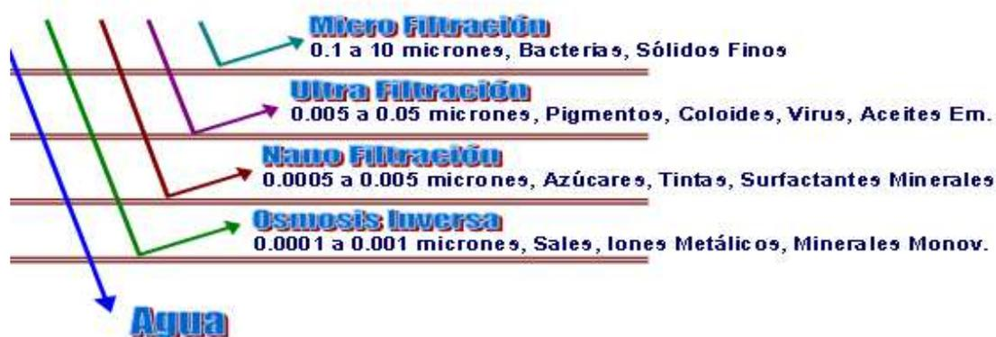
Figura 7. Tamaño de los poros de las membranas en los distintos tipos de filtración.
