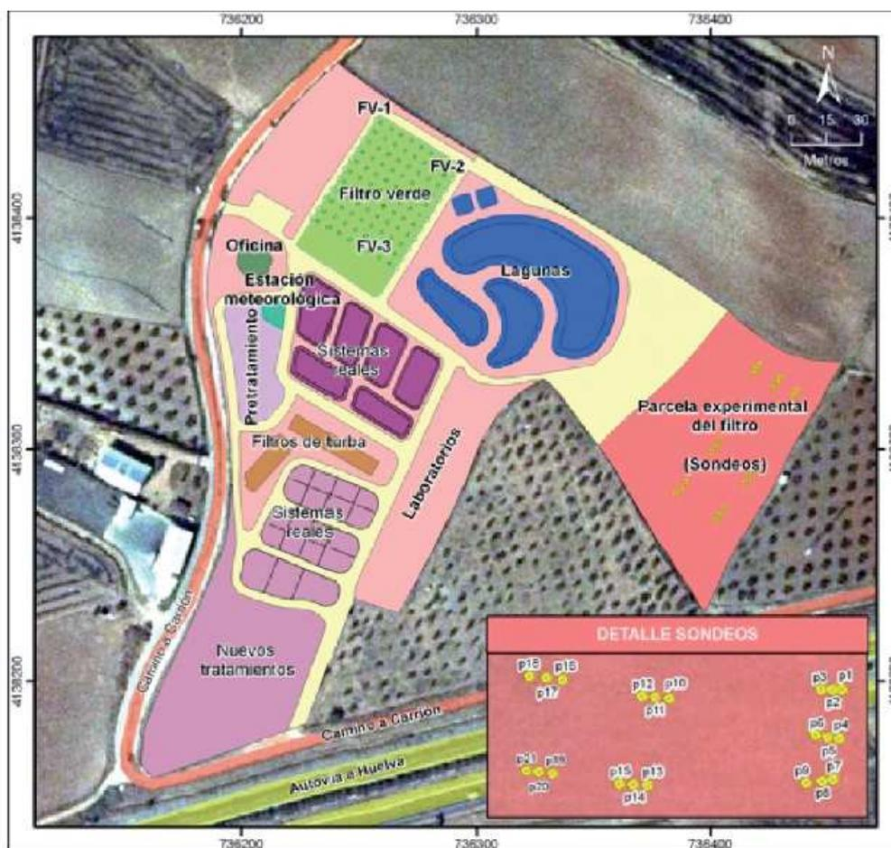
Figura 29. Esquema general de la Planta Experimental de Carrión de los Céspedes-PECC (Sevilla) y localización de los piezómetros instalados y de las secciones geofísicas realizadas. Fuente: Irene Bustamante et al. (2011)
