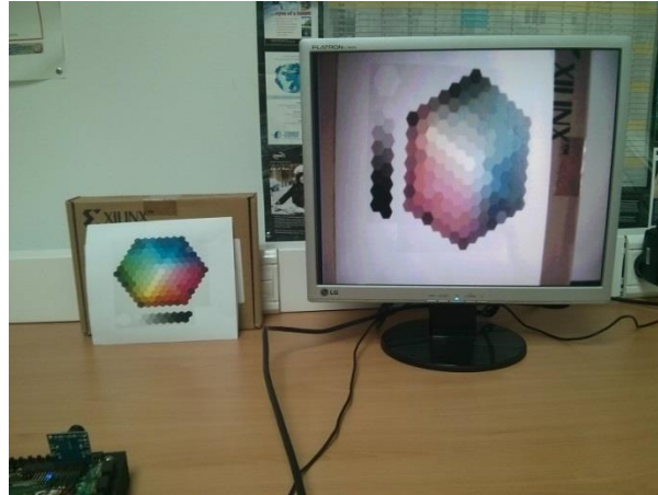
Figura 61. Prueba con AGC y AEC desactivados
