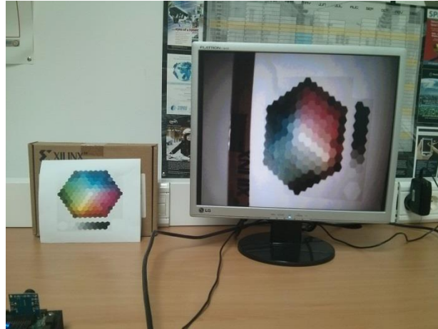
Figura 65. Prueba con modo espejo y VFlip
