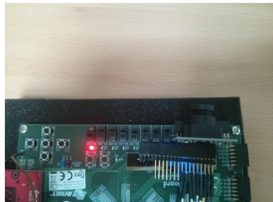
Figura 56. Interruptor activado para modo suspensión
