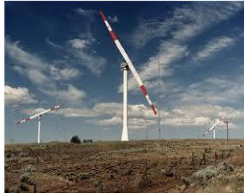
Figura 35 – aerogenerador de 2 palas
