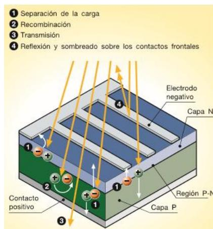
Figura 43 – Efecto fotovoltaico.
