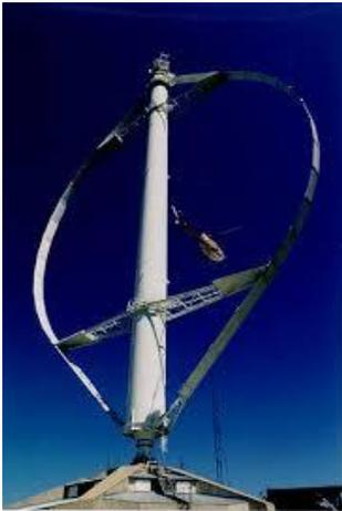
Figura 31 – Aerogenerador Darrieus
