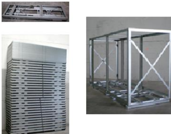
Ilustración 50: Estructura metálica para embalaje de motocicletas
