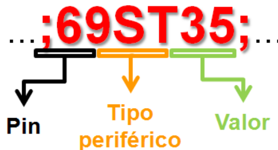
Figura 4.24: Estructura del estado de los pines en telemetría.
