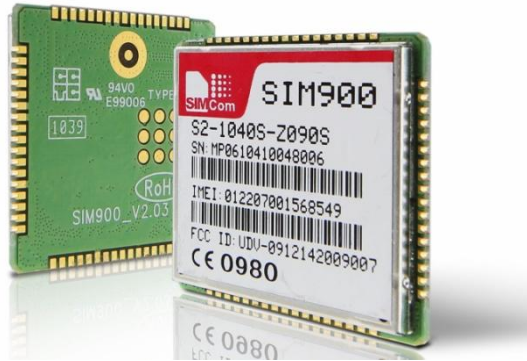
Figura 2.6: Módulo GSM/GPRS SIM900.
