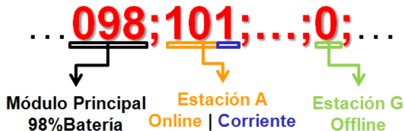
Figura 4.25: Estructura datos generales Módulo Principal y Estaciones.
